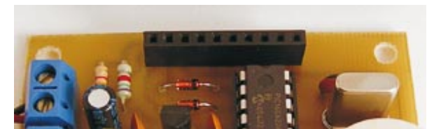
Рис.13 Монтаж разъёма "гнездо" на плату устройства.
